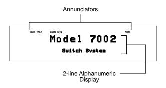
Figure 4-1 Vacuum fluorescent display (VFD)
